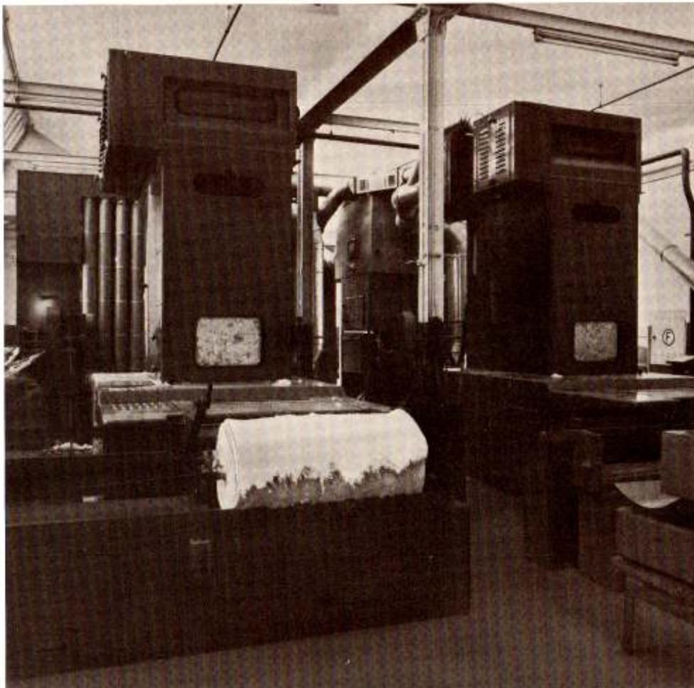
Automatischer Auswurf fertiger Wickel
